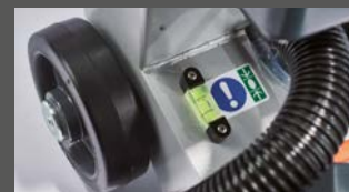
Износостойкие колеса (не оставляют полос) для чистой работы
