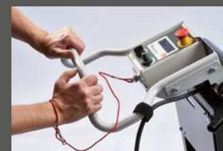
Выключатель мертвеца для безопасной работы
