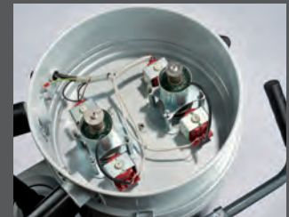
Automatische mechanische Filterreinigung
