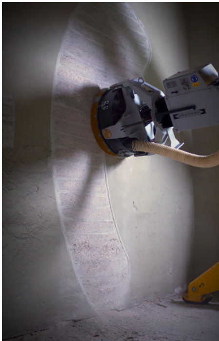
Große Flächen können professionell strukturiert werden – mit konstant hohem Anpressdruck.
