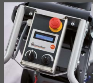
Display mit Leistungsanzeige und Betriebsstundenzähler
