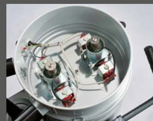
Автоматическая механическая очистка фильтра
