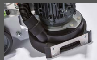
Szlifowanie i polerowanie bez pozostawiania krawędzi / wychylana głowica
